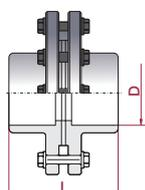
**Комплект фланцевый ПВХ CEPEX (2 жестких фланца, болты, гайки, шайбы)**
